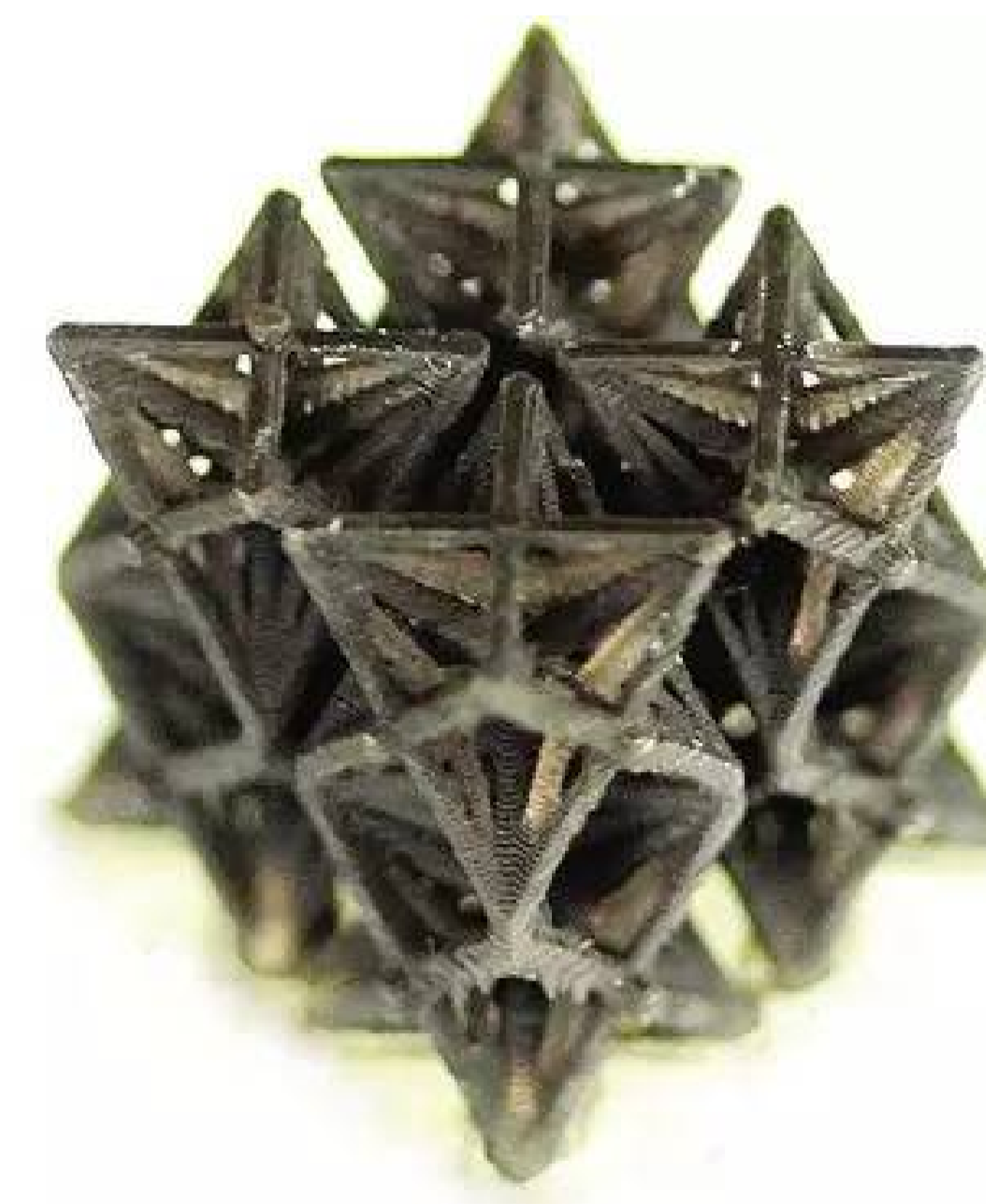
图 19 3D 打印制备的热收缩超材料
