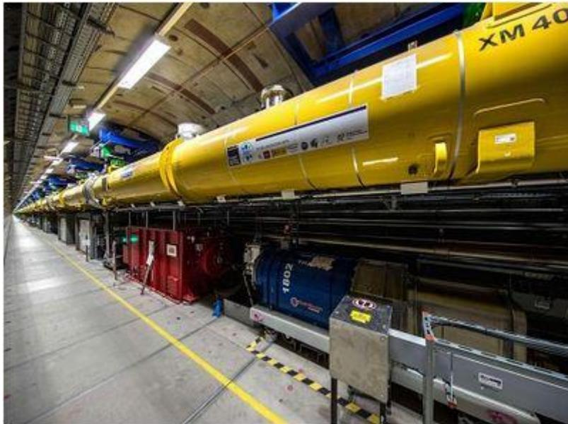
图 11 XFEL 的长达 2.1 公里的加速器管道与悬挂在天花板上的黄色超导加速器模块
