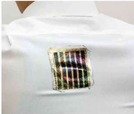
图 5 日本研发出能伸缩能水洗的超薄太阳能电池 可贴在衣服上
