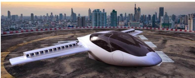
该双座轻型飞机采用碳纤维制成，拥有 36 台由几千部锂离子电池供电的喷气发动机，消耗了当今最高效电动汽车的一半能量，并配有降落伞作为终极安全备用。飞
