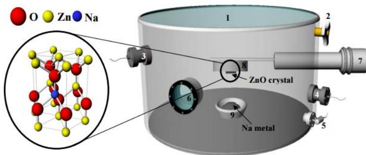
钠掺杂室示意图。(1) 室内玻璃盖 (2) 开/关阀 (3) 热通道供给 (4) 热电偶进给 (5) 泵连接器 (6) 通道 (7) 机械手 (8) 按钮加热器 (9) 氧化铝中的 Na 金属。
