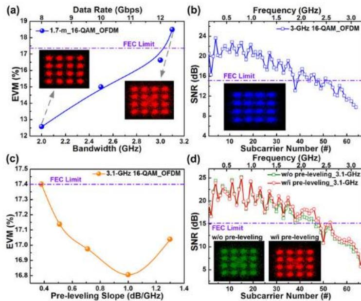
通过 1.7 米自来水通道的最大数据带宽和 450nm 蓝色 LD 携带 16-QAM OFDM 数据的相关传输参数。(a) 通过 1.7 米以上自来水传输的不同带宽的 16-QAM OFDM 数据的 EVM 和相关星座图。(b) 在自来水下 1.7 米传输后的 12-Gbps 16-QAM OFDM 数据的副载波 SNR 和相应的星座图。(c) 1.7 米水下传输后的 12.4 Gbps 16-QAM OFDM 数据的 EVM。(d) 没有并具有预调平的 1.7 米自来水发射的 12.4-Gbps 16-QAM OFDM 数据的子载波 SNR 谱和相关星座图。
