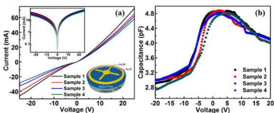
MgZnO MSM 器件的电性能。图 (a) 样品 1-4 的 I-V 特性。左上方的插图显示了 I-V 数据的半对数图。右下图显示了 MSM 设备的原理图。图 (b) MgZnO MSM 器件的 C-V 特性（样品 1-4）。
