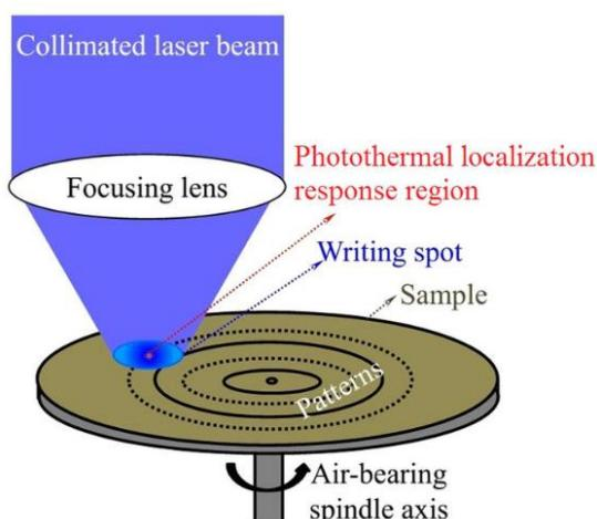
上图为在 AgInSbTe 涂层样品上的高速无掩模纳米光刻技术的示意图，其中由于光热定
