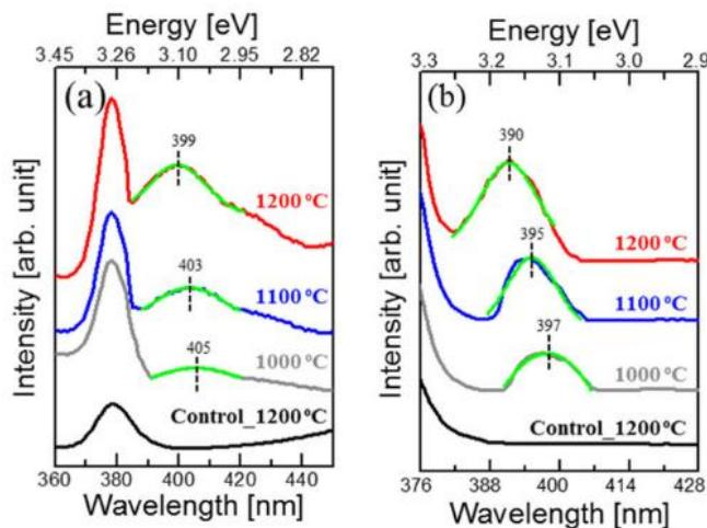
室温光致发光 (PL) 和激发 (PLE) 测量。(a) PL 发射，显示 Na 掺杂后 DAP 发射的出现。(b) 用于对照试验的 PLE 光谱。Na 掺杂浓度增加至  $1020\text{cm}^{-3}$ ， $\text{Na}_{\text{Zn}}$  吸收带蓝移为  $0.08\text{eV}$ 。DAP 峰通过单一高斯模型拟合，如绿色所示。为了清晰起见，数据垂直移动。
