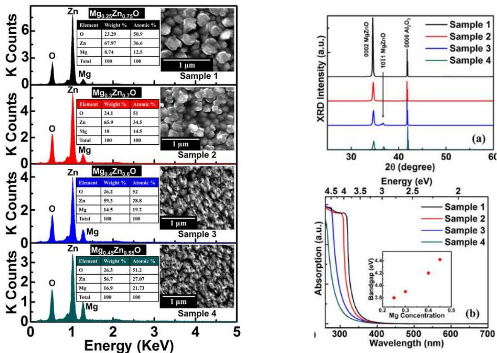
左图为 MgZnO 薄膜的组成和形貌。分别为样品 1 ( $Mg_0.25Zn_0.75O$ )，样品 2 ( $Mg_0.3Zn_0.70$ )，样品 3 ( $Mg_0.4Zn_0.60$ ) 和样品 4 ( $Mg_0.45Zn_0.55O$ )。右图为 MgZnO 薄膜的结构和带隙特性。(a) MgZnO 薄膜的 XRD 光谱 (样品 1-4)。(b) MgZnO 薄膜的室温吸收光谱 (样品 1-4)，插图显示了膜中 Mg 含量的带隙变化。
