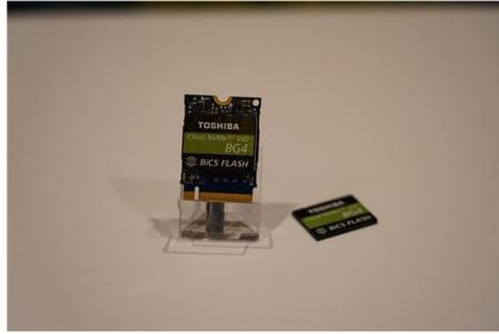
这款新系列的单一封装固态硬盘采用 PCIe® Gen3x4 通道，提供高达 2250 MB/s 的循序读取效能，并以更出色的快闪存储器管理，提供领先业界的随机读取效能，最高可达 380000 IOPS。
