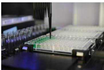
先进液体处理机器人执行聚合物合成的化学反应
