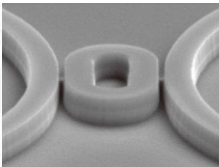
图 3 电泵浦拓扑绝缘体激光器结构，由 10 \times 10 微环腔网络组成，这些微环腔通过链路谐振器相互耦合
