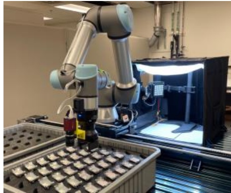
复杂金属零件缺陷自动检测机器人
