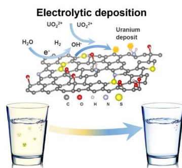
图 石墨烯泡沫用作原位电解沉积电极
