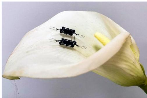
图 人造肌肉驱动的微型飞行机器人
