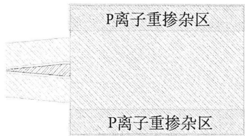
图 3.12 Si 上欧姆接触重掺杂区对应版图 NSS
