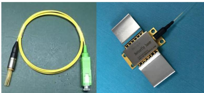
图 2.4 DFB 激光器封装实物图：同轴封装（左）和蝶形封装（右）
