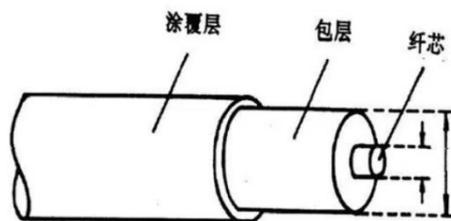
图 2.11 光纤结构图
