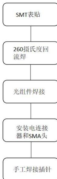
图 3.16 微组装流程图
