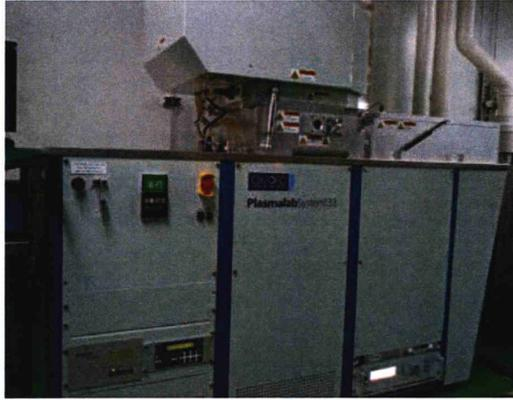
图 3.15 深硅刻蚀设备 ICP380
