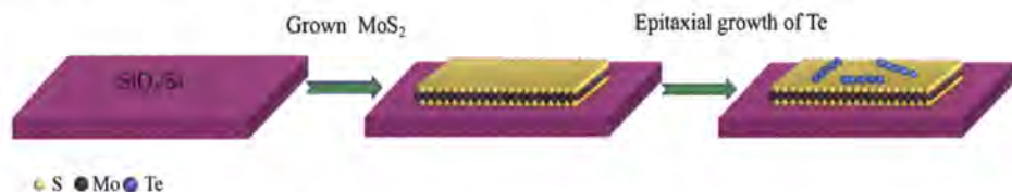
图 2.1 Te/MoS 2 异质结构的外延生长示意图。
