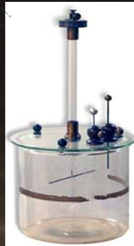
Coulomb Torsion Balance 库伦的扭称-卡文迪许加镜子 沈括的悬丝法
