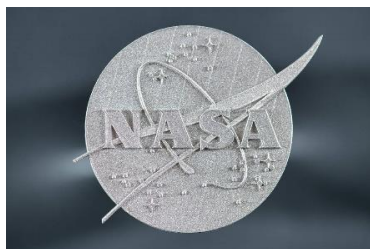
使用新合金材料进行 3D 打印 的 NASA 图标
