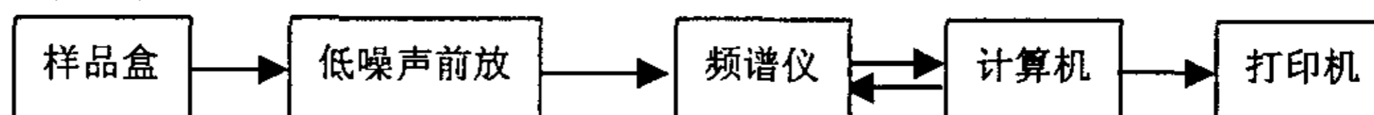
图 2-1 LD 噪声直接测量框图
