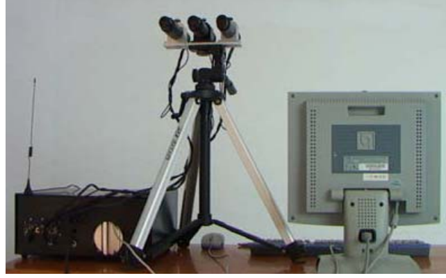
图 2.3 三波长闪烁仪实物图
