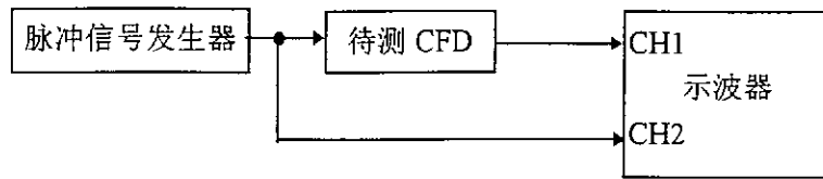
图 6.1.1 用示波器测示 CFD
