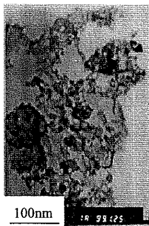
图 2.2 以乙二醇独甲醚为溶剂获得的硫化镉超微粒的 TEM 照片
