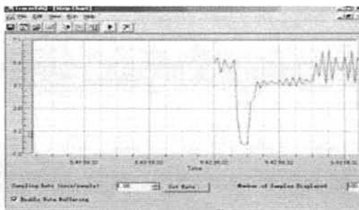
图 3.63 高压气突然释放响应曲线
