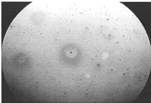
图 3.37 极限参数下玻璃表面析出的钠络合物
