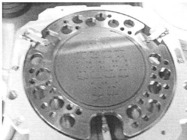
图 3.38 析出物通过燃料孔、测压孔沉积在底座上
