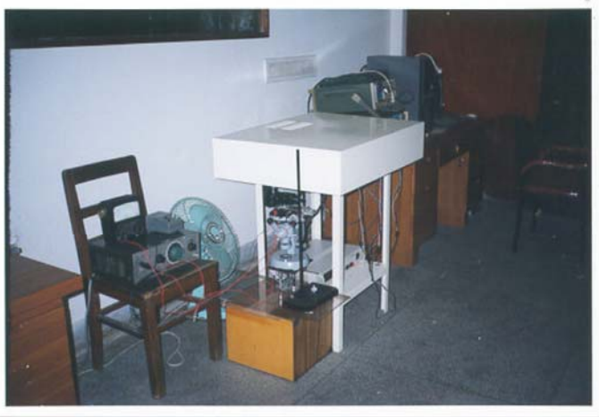
图 2-5 四色荧光微流控芯片装置外观图
