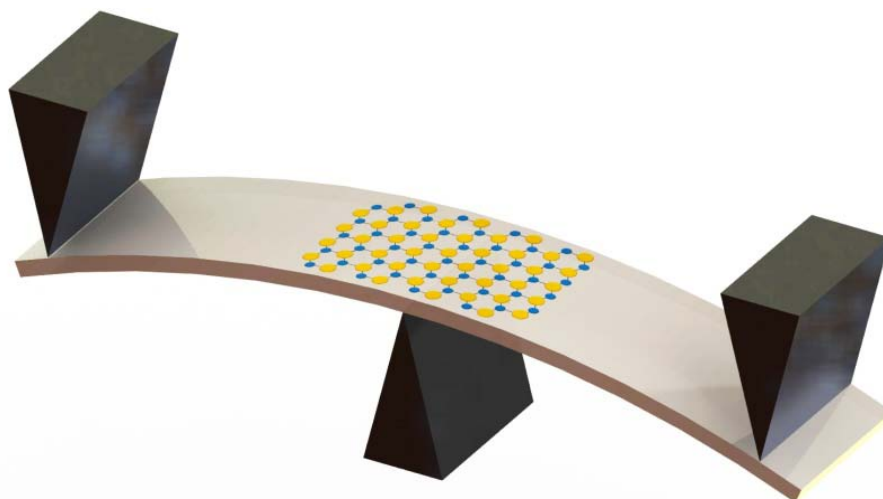
图 7.8 三点弯曲应变施加装置示意图。
