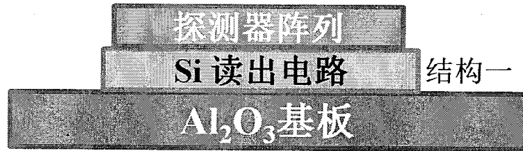
图 4.15 焦平面器件直接封装结构（结构一）
