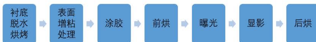
图 5.8 电子束曝光的工艺流程
