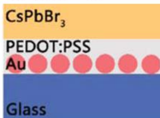
图 3.24 CsPbBr 3 钙钛矿与金纳米粒子在缓冲层中结合的器件结构示意图[222]。
