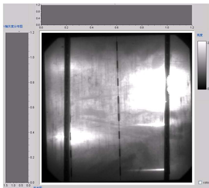
图 5-2 背面 80nm 氮化硅+10nm 氧化铝叠层钝化电池 EL 图
