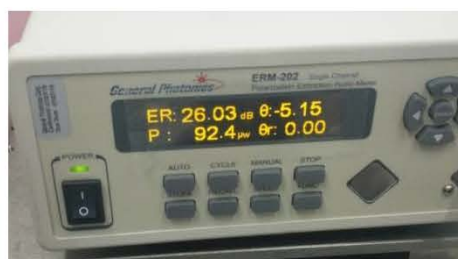
图 3.16 45 度倾斜光纤光栅消光比实测图
