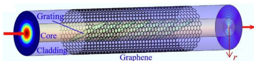
图 1.15 大角度倾斜光纤光栅和石墨烯的混合波导模型[60]
