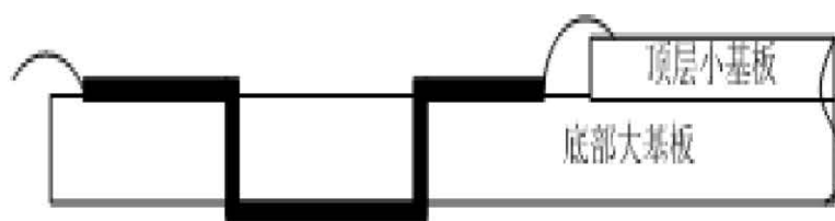
图 3.6 多层基板剖面图 Fig 3.6 Section plane of motherboard
