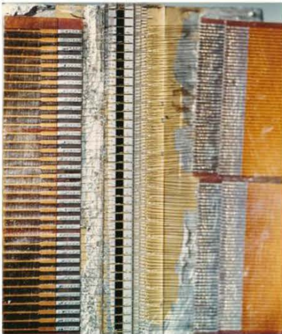
图 1.7 德州仪器公司 180 元光导线列器件与其杜瓦封装样式 Fig 1.7 180 elements photoconductive line array device and its packaging of Texas Instrument
