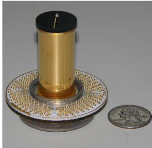
图 1.7 德州仪器公司 180 元光导线列器件与其杜瓦封装样式 Fig 1.7 180 elements photoconductive line array device and its packaging of Texas Instrument
