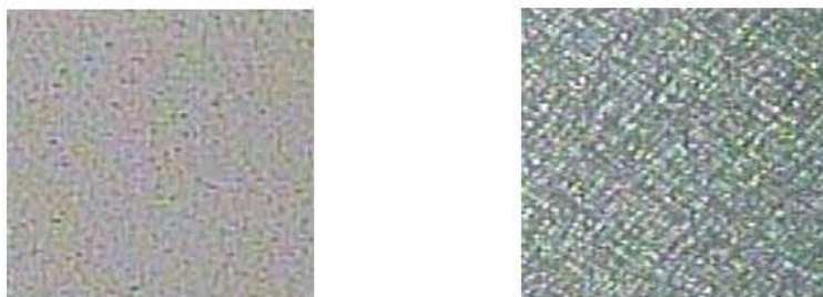
图2.2.3平面型外延材料的光学显微镜照片(左边为InGaAs为缓冲层、InP为帽层的外延材料,右边InAsP为帽层和缓冲层的外延材料)
