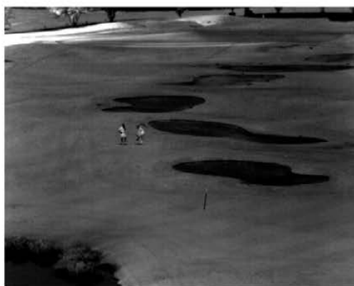
图 1.7.3 传感无限公司研制的 InGaAs 双波段焦平面的成像效果（无月光、距离 450 米） Fig.1.7.3 The image capture on a dark (moonless night) using the VIS-NIR InGaAs FPAs at distances of approximately 450m
