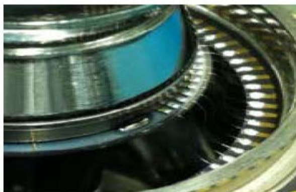
图 1.8 我所研制的 FPA 杜瓦采用的金属丝引线结构
