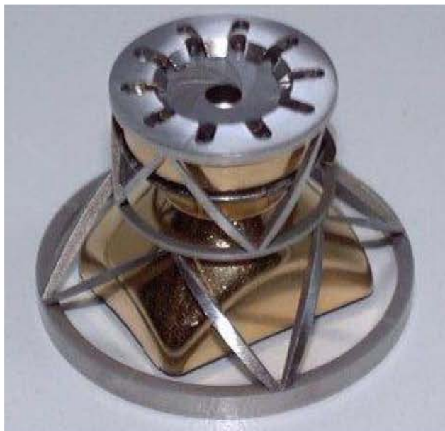
图 2.3 FLIR 系统中的可调冷光阑结构
