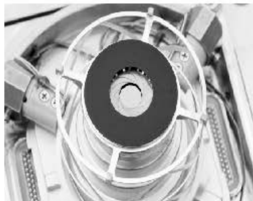
图 2.2 美国 Raytheon 公司研制的可调节光圈大小的 FPA 杜瓦组件
