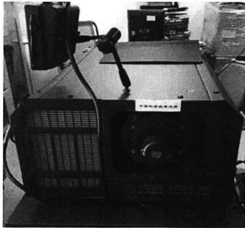
图 1-2 中科院研制的 140 寸大屏幕背投激光投影样机
