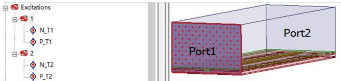
图 3.31 简化模型波端口与终端概况
