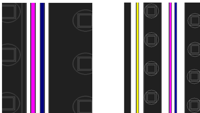
图 4.15 差分线&单端线 GS 间距控制优化
