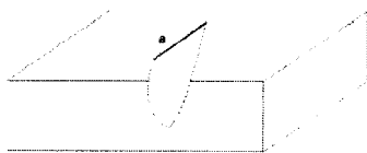
图 1-23 半硬币状的裂纹模型图
