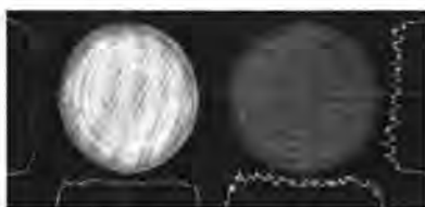
图 1.12 130 mJ/300 Hz/90 ps Nd:YAG 皮秒激光系统及放大后的光斑分布 [25]
