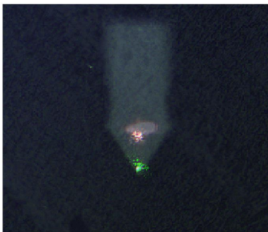
图 3.7 s-SNOM 内置相机图像。 将黑色塑料片置于样品平面并将中红外探针的绿色引导激光聚焦移动到保存图片的探针尖端位置。
