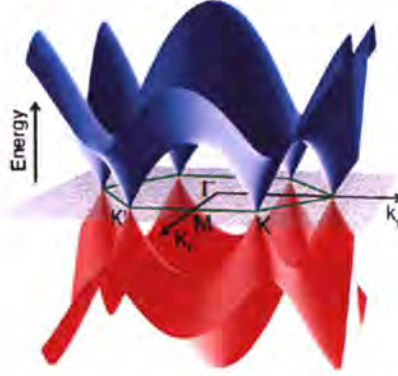
图 1.3 单层石墨烯的能带结构图，摘自文献 [58] 。
