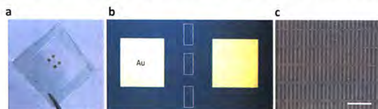
图 3.11 (a) 刻蚀 \text{SiO}_2 以后 PMMA 薄膜支持的器件。(b) 将(a)中的器件转移至氟化钙基底以后的光学照片。(c) 转移至氟化钙基底上石墨烯纳米条带的 SEM。
