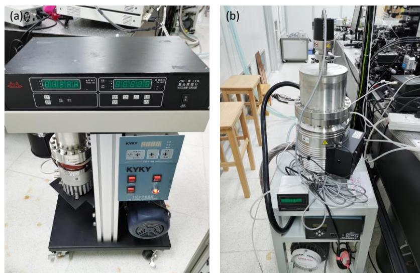
图 4.3 分子泵外观。(a) KYKY 分子泵，(b) Leybold 磁悬浮分子泵。
