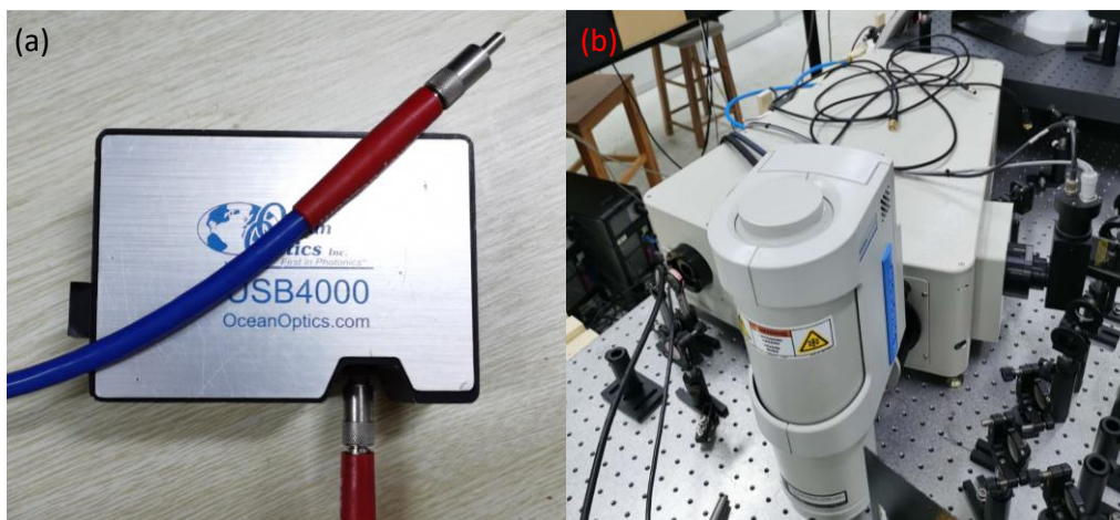
图 4.5 光谱仪外观。(a) 手持式光谱仪，(b) iHR-550 型光谱仪。
