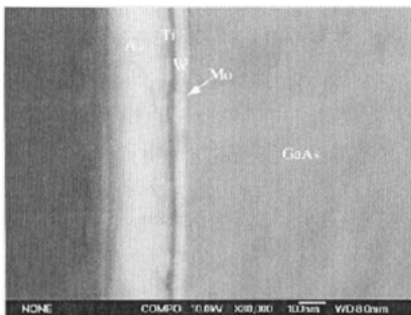
图 2.22 合金化前 Mo/W/Ti/Au 和 n-GaAs 接触的背散射电子像
