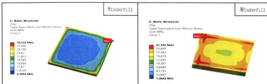
图 3.14 TCV 封装结构芯片的热应力分布(有无 Underfill)
