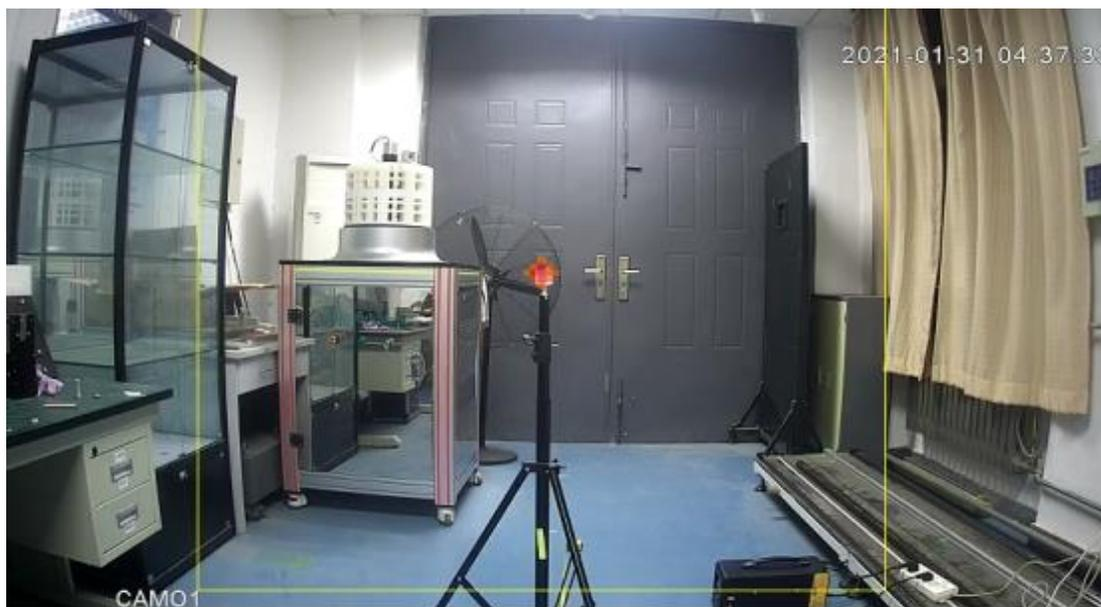
图 5.21 1mCi<sup>137</sup>Cs 放射源 2m 距离时 90s 成像结果
