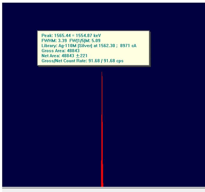
图 5.4 前放电路噪声测试：未进行能量-道址校正
