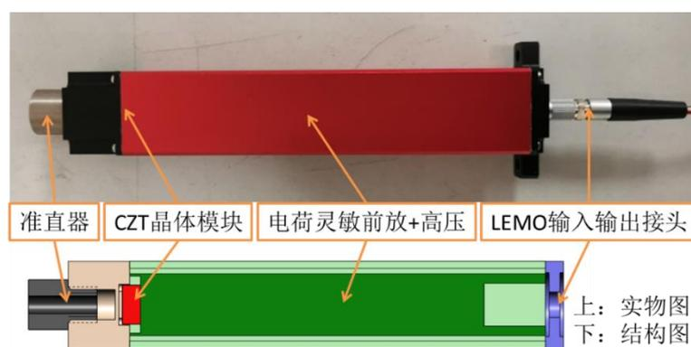
图 5.2 能谱仪中碲锌镉探测器探头外观及内部结构
