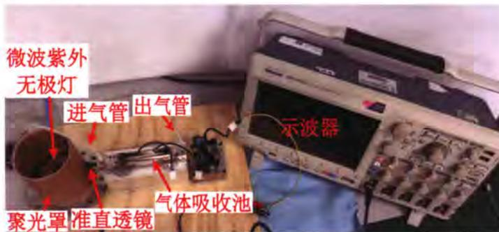
图 5.8 基于微波无极紫外灯的非分散紫外吸收光谱 SO<sub>2</sub> 气体传感器
