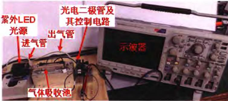
图 5.9 基于紫外 LED 光源的非分散紫外吸收光谱 SO<sub>2</sub> 气体传感器
