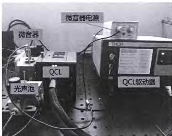
图 5.12 基于 QCL 激光光源的光声光谱气体传感器
