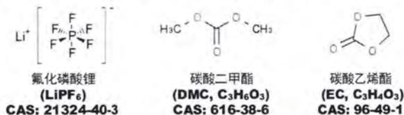
图 4.11 LiPF<sub>6</sub>、DMC 和 EC 的化学结构
