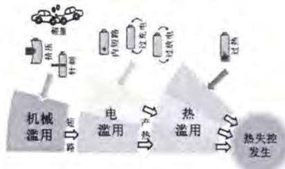
图 4.2 锂离子电池热失控触发因素之间的联系
