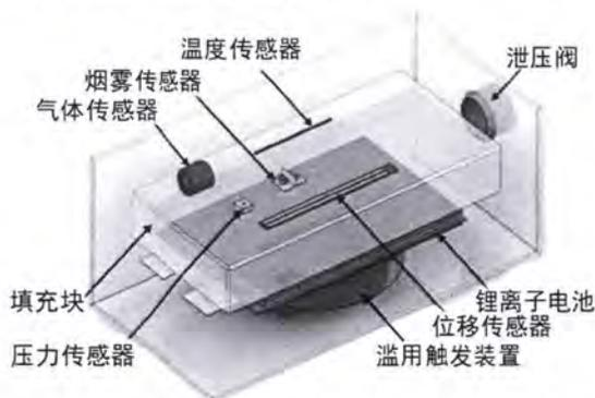
图 1.1 多种传感器对比监测锂离子电池组热失控<sup>[10]</sup>
